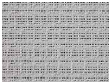
Polyestergewebe Gewebe aus hochfesten Polyesterarnen, vorgereckt und PVC-fixiert
