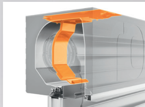
Blendrahmenstabilisierung Für optimale Windlastabtragung bei großen Fensterflächen
